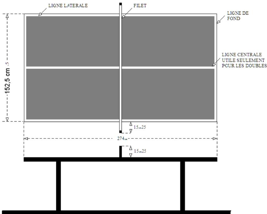
**2.1.4** - La surface de jeu doit être de couleur uniformément foncée et mate ; elle est limitée en ses quatre côtés par une bande blanche de 2 cm de large. Les bandes blanches situées sur les longueurs de la surface de jeu s'appellent "lignes latérales" et celles situées sur les largeurs s'appellent "lignes de fond".
